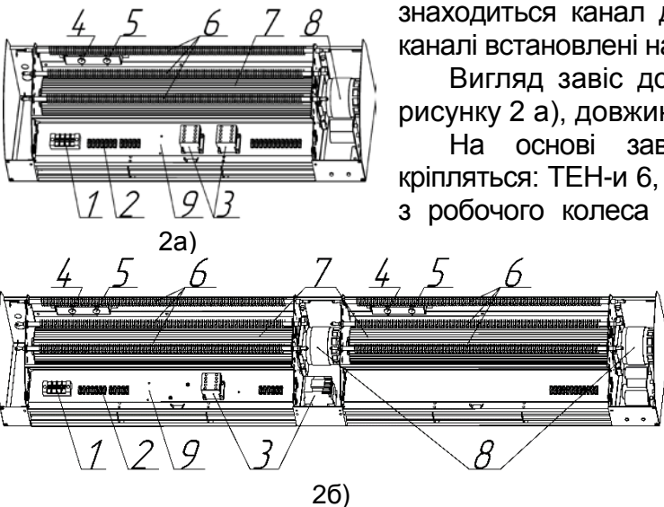
Рисунок 2 Загальний вигляд завіс а) завіси довжиною 850 мм і 1000 мм; б) завіси довжиною 1600 мм
